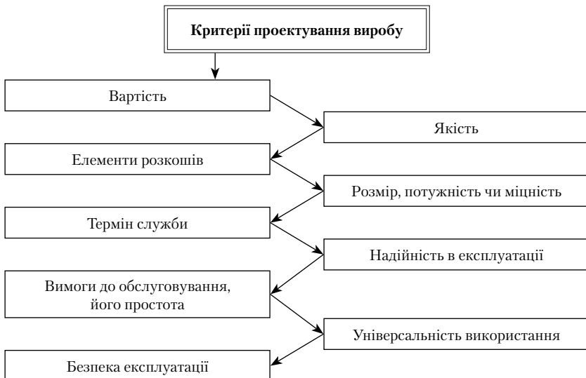
Рис. 23. Основні критерії проектування виробу
